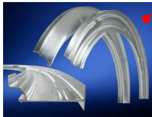
CF34-10 Torque Box Ring, (Embraer 190)
